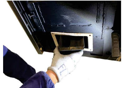
Fig. 81 - Remove the fume diverter
