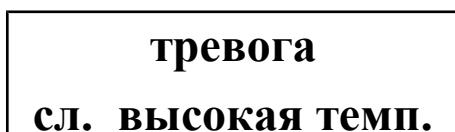
Текущая температура считывается с электронного датчика и преобразовывается терморегулятором. В случае превышения температуры тревоги отключается вентилятор и одновременно начинают работу оба насоса, для распределения горячей воды по отопительной установке дома
