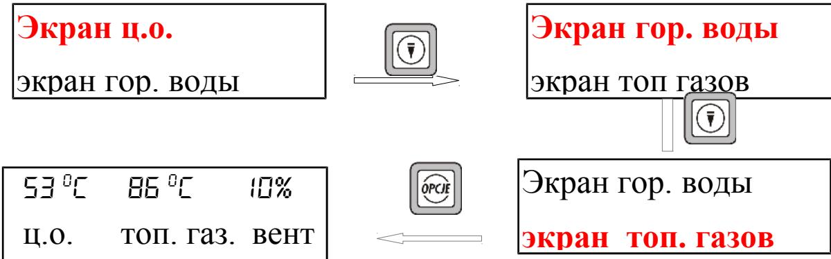
С левой стороны дисплея показывается температура котла, посередине – температура выхода топ. газов, а с правой стороны – текущая мощность вентилятора (выраженная в процентах). Чтобы возвратиться в главное меню, следует нажать кнопку **ВЫХОД**.
