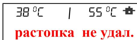
В таком случае следует повторить запуск функции *растопка*, регулятор снова начнет процесс растопки.
