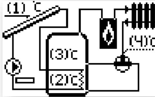
Эта система позволяет пользователю управлять клапаном возврата системы ЦО в накопительный бак. Клапан переключает циркуляцию с верхней части бака в нижнюю.
